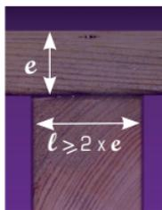
**2** La largeur des lambourdes ( $l$ ) doit être au minimum de 2 fois l'épaisseur de la lame de terrasse ( $e$ ).
