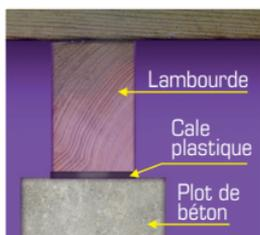
**3** Pour conserver un bon écoulement de l'eau et éviter tout contact avec le sol, il est préférable de placer des cales en caoutchouc sous les lambourdes.
